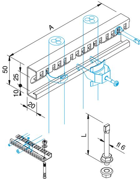
**LANZ Kombisprossen** können solide mit Dübel direkt auf dem Rohboden montiert werden. Befestigung der Kabel mit Kabelbinder **oder** mit Schnellverlegern. – Ortstrennung mit Ordnungs-Trennbolzen.
